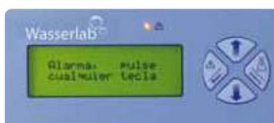
El microprocesador avisará de forma preventiva, mediante aviso acústico y mensaje escrito en la pantalla, de las tareas de mantenimiento necesarias para garantizar la calidad de agua deseada.
